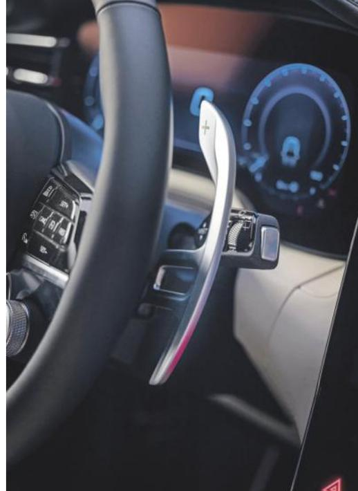
■ Particolari della strumentazione e del posto guida della Modena: come su tutte le Grecale, i paddle che azionano il cambio, realizzati con alluminio e di dimensioni generose, sono solidali con il piantone dello sterzo
