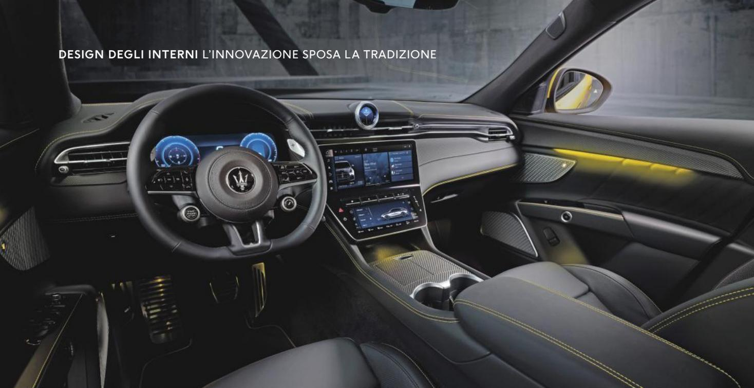
■ Come in tutte le versioni della Grecale, il tunnel centrale della Trofeo (sopra) è privo della tradizionale leva del cambio automatico; il comando, detto Pnrd (M) (dalle iniziali delle funzioni: parcheggio, neutral, cioè folle, retromarcia e drive-manuale), è costituito da una linea di tasti posti tra il display dell'infotainment e quello dedicato al confort
