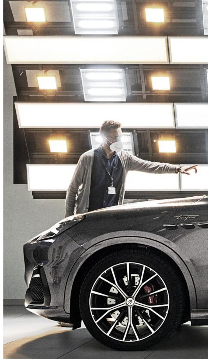
■ Nella sala Ascari, lo Skylight simulator (sopra) rende possibile riprodurre qualsiasi condizione di luce di qualunque parte del mondo, per verificare la resa dei colori e i riflessi, che possono rendere poco leggibile la strumentazione
