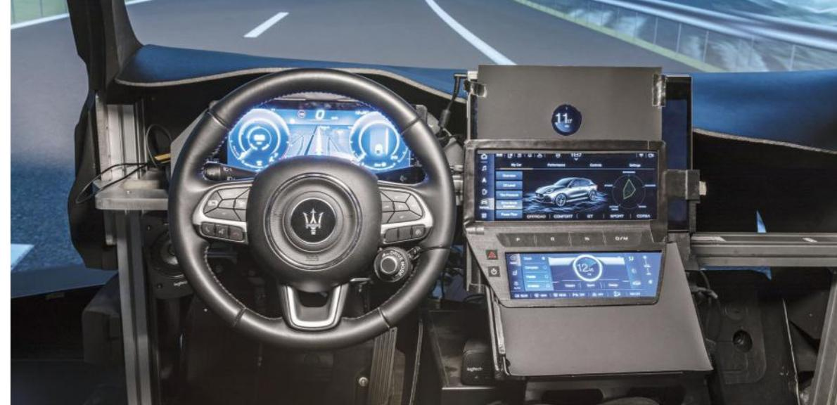
■ A fianco e sotto, a sinistra, l'esempio di una plancia completa di schermi e comandi funzionanti, che consentono di convalidare l'efficacia dei processi sviluppati dalla software factory interna della Maserati. Questi simulatori permettono di lavorare contemporaneamente anche su più progetti
