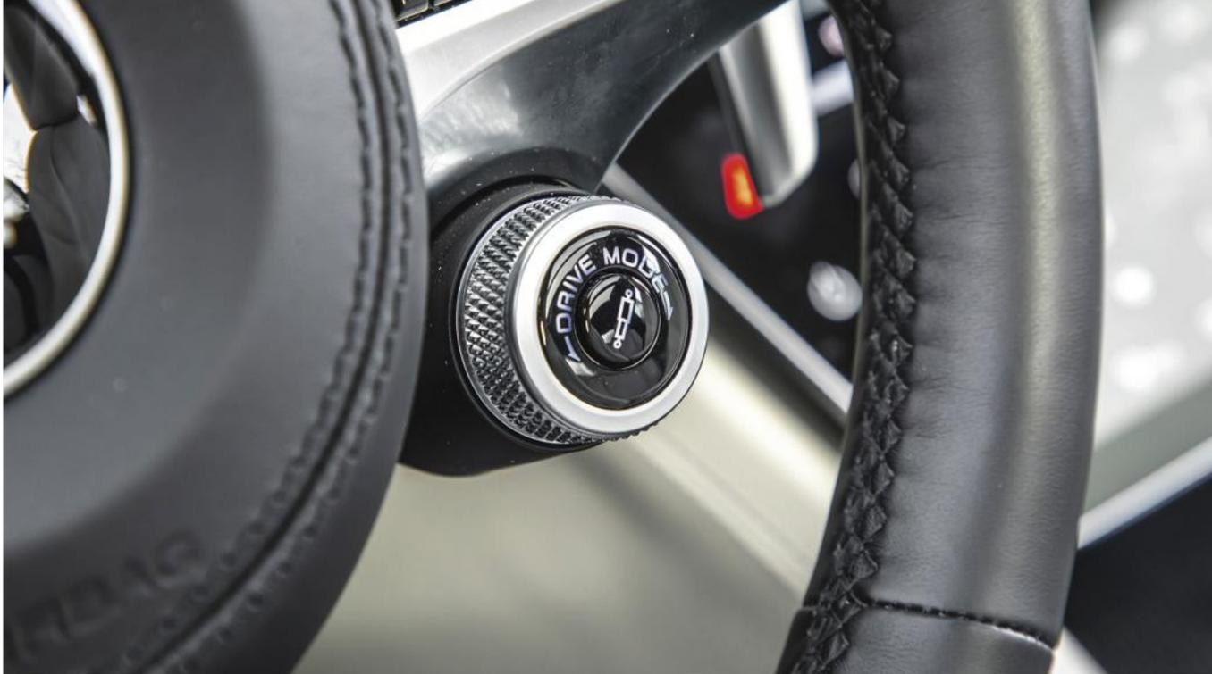
■ Il selettore del Drive mode (sopra, quello della Grecale Modena, con al centro il tasto per la regolazione degli ammortizzatori) è stato posto sotto una delle razze del volante, per essere immediatamente raggiungibile dal guidatore
