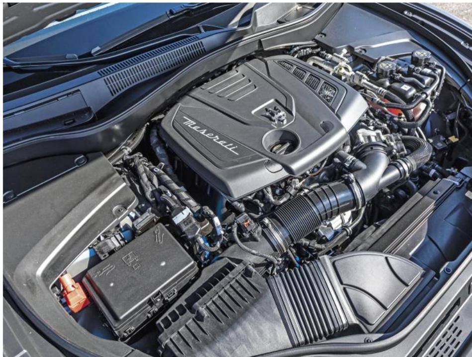
■ Il quattro cilindri ibrido (sopra a destra) viene adottato inizialmente dalla Maserati sulla berlina Ghibli, per poi essere impiegato anche sulla Levante. Eroga 330 CV e una coppia di 450 Nm, disponibile a 2.250 giri/min, che consentono alla Suv di raggiungere i 240 km/h e di accelerare da 0 a 100 in 6 secondi
