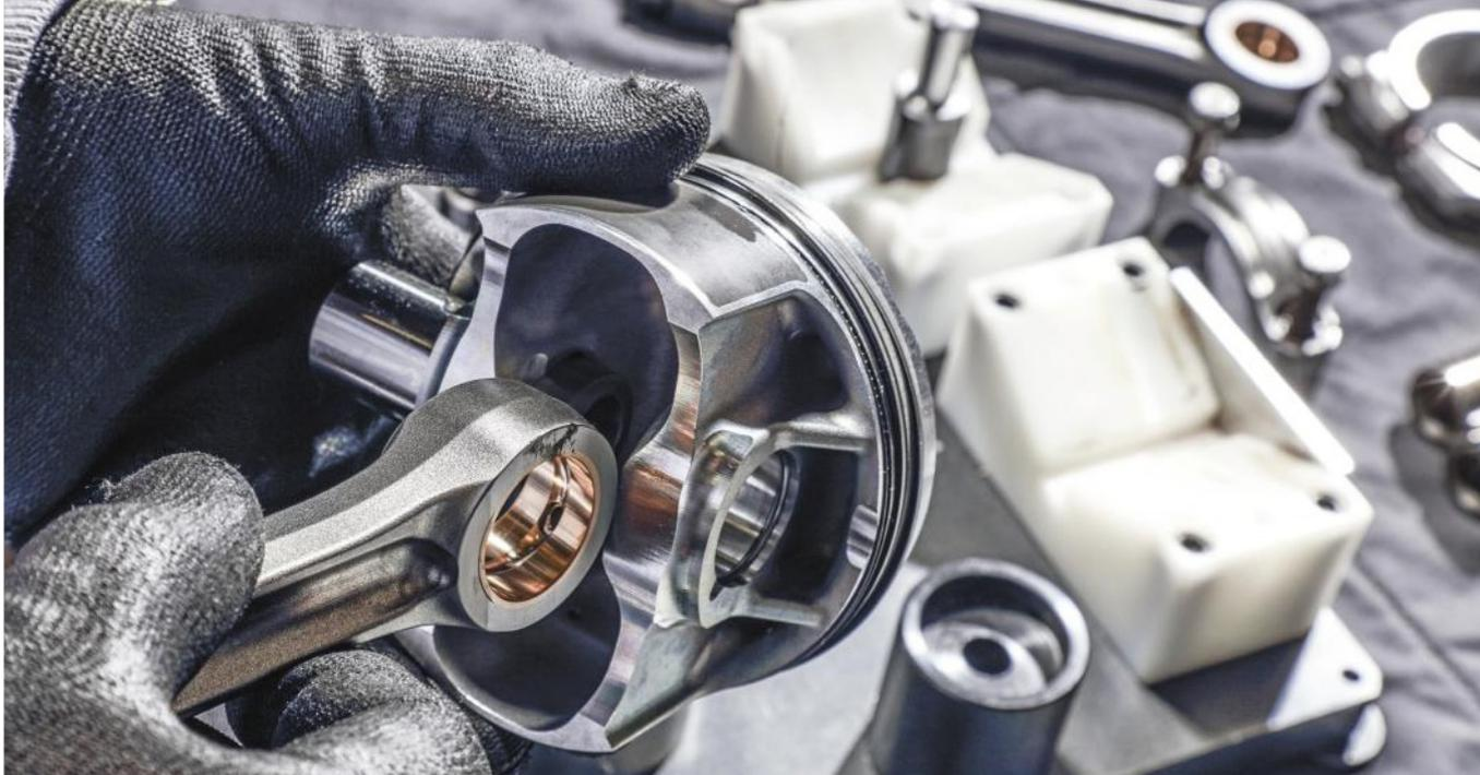
■ Nella pagina a fianco e qui sopra, altre fasi di lavorazione del sei cilindri Nettuno, il cui assemblaggio avviene poi in una camera ad atmosfera controllata per evitare che microparticelle di polvere possano compromettere le tolleranze di pochi micron ammesse tra i componenti
