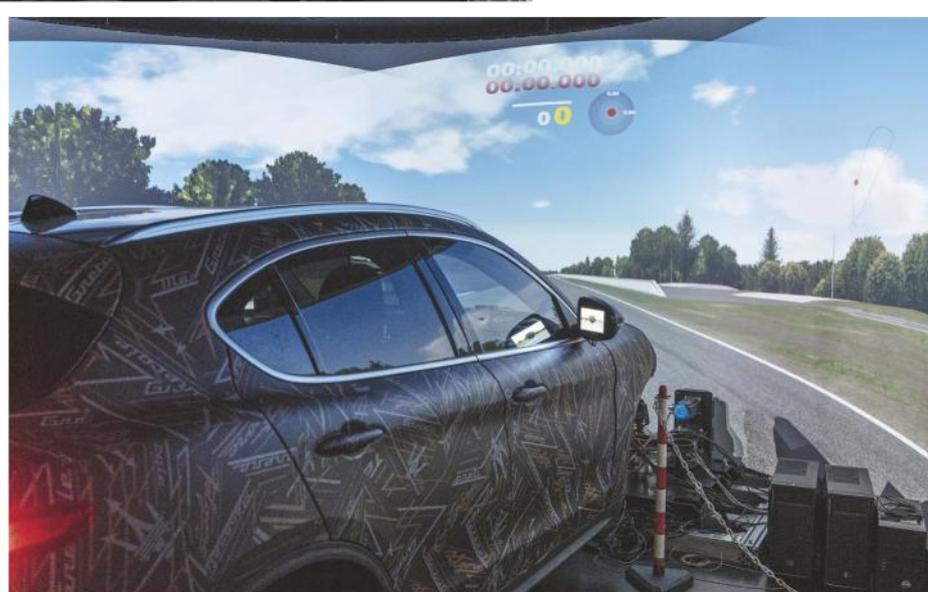
Questo è possibile grazie al collegamento in fibra ottica con la sede di via Ciro Menotti, dove si trovano le sale prova di tutti i motori, termici e no, le cui risposte vengono trasferite in tempo reale al simulatore».
