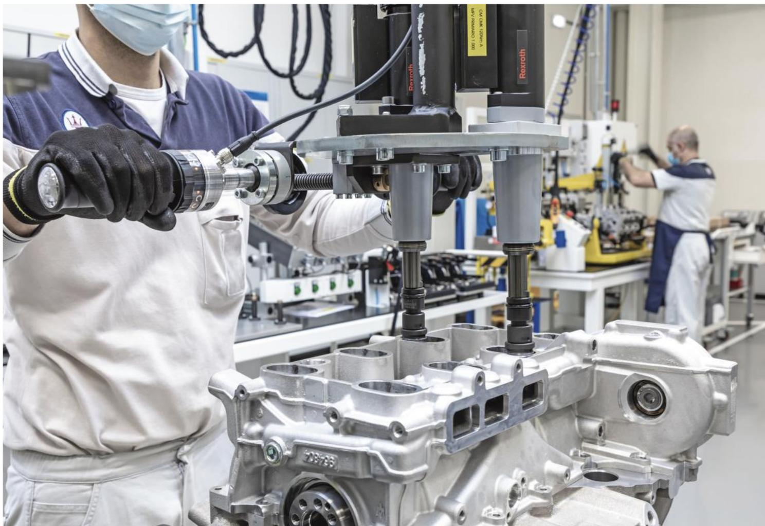
■ Operazioni della fabbricazione del motore Nettuno: qui sopra, il serraggio del sottobasamento del motore; a destra, il controllo delle fasi della distribuzione. Peculiare di questo motore, sia nella versione destinata alla MC20 sia in quella della Grecale Trofeo, è il sistema brevettato con precamera di combustione
