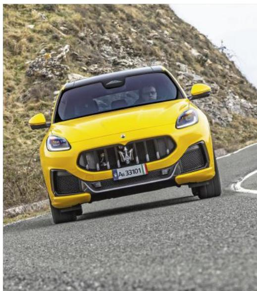
avendo aumentato la rigidezza locale degli attacchi delle sospensioni, abbiamo potuto adottare gomme meno rigide, garantendo una precisione delle geometrie inalterata, ma ottenendo benefici nel filtraggio delle asperità della strada».
