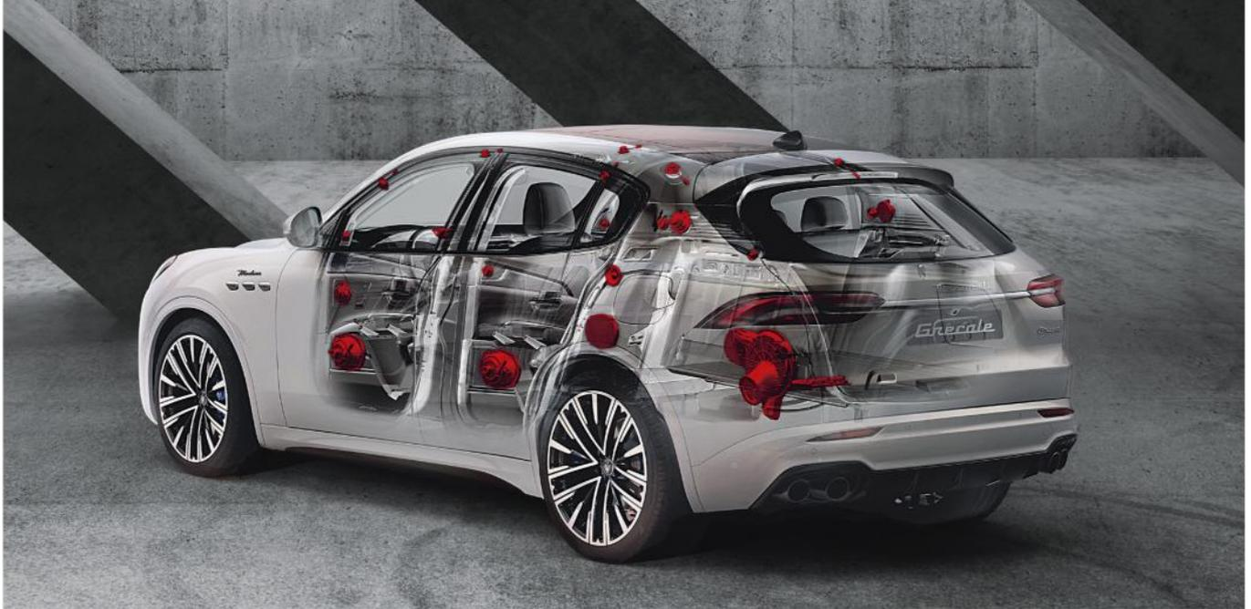
to, anche per degli utilizzi che, in viaggio, possono prolungarsi per parecchie ore; un risultato ottenuto sia con una collocazione adeguata degli speaker sia con l'uso di materiali – come la seta per la cupola dei tweeter e la polpa di carta per i coni dei midrange – che garantiscano una risposta di frequenza più equilibrata e un panorama sonoro molto ampio e dettagliato.
