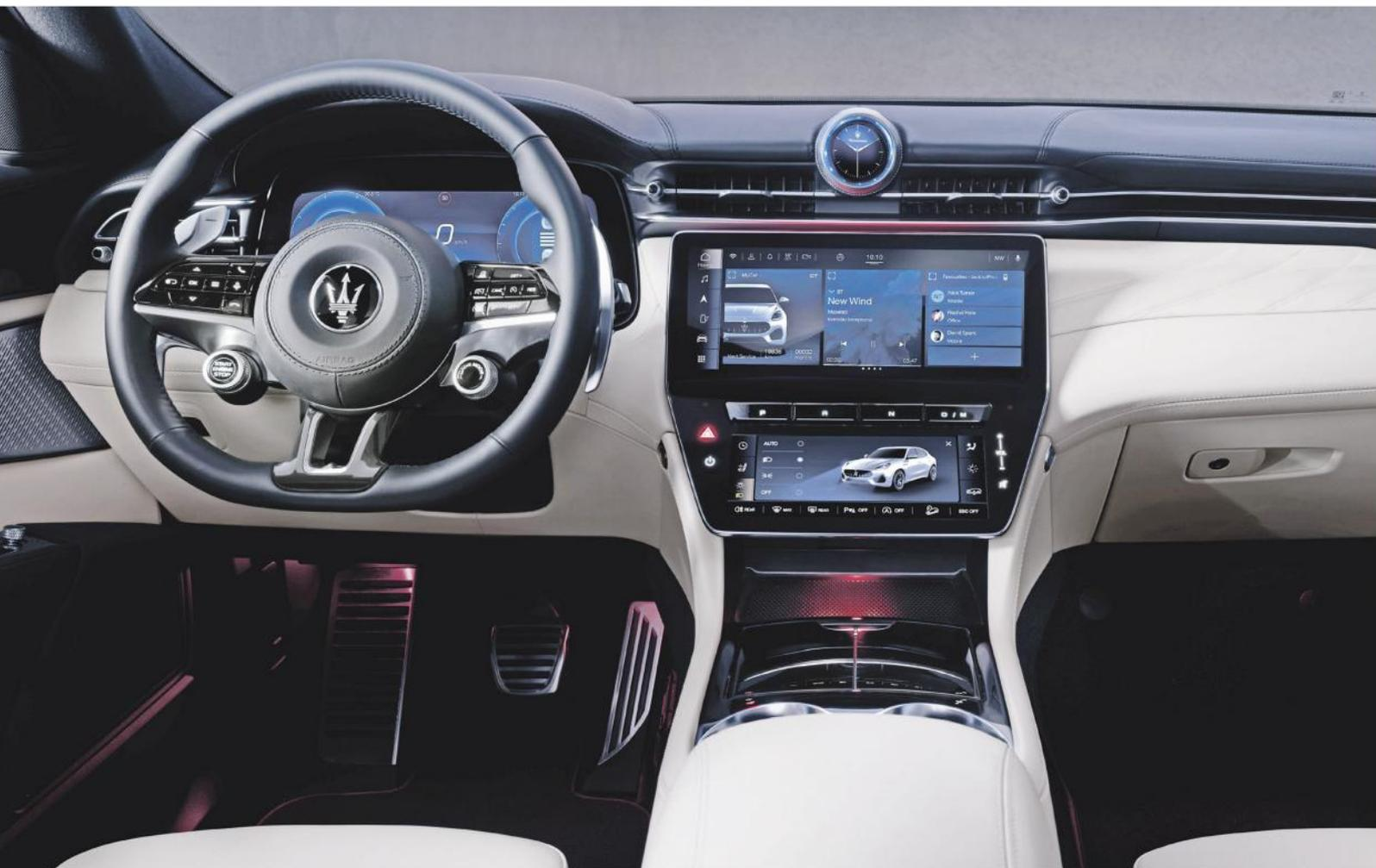
Sopra, la plancia della Grecale Modena: il numero di comandi fisici è stato considerevolmente ridotto, ma sul volante ne rimangono alcuni essenziali. In particolare, si tratta di quelli relativi all'impianto audio, al telefono, agli Adas, alla messa in moto della vettura e al selettore delle modalità di guida (il manettino Drive mode)
