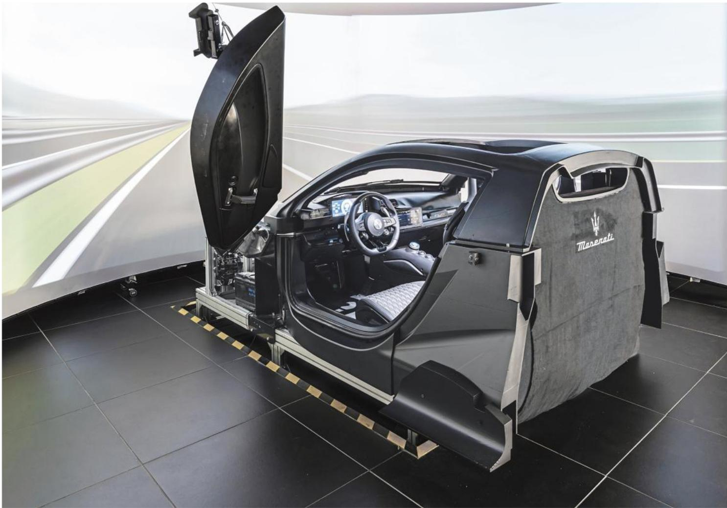
■ Questo simulatore statico è impiegato per sviluppare la postura di guida, l'ergonomia del veicolo e l'interfaccia uomo-macchina: l'esperienza utente viene studiata nella prima fase con un approccio virtuale. All'interno della scocca sono installati prototipi dei display e dei comandi, per testarne la funzionalità
